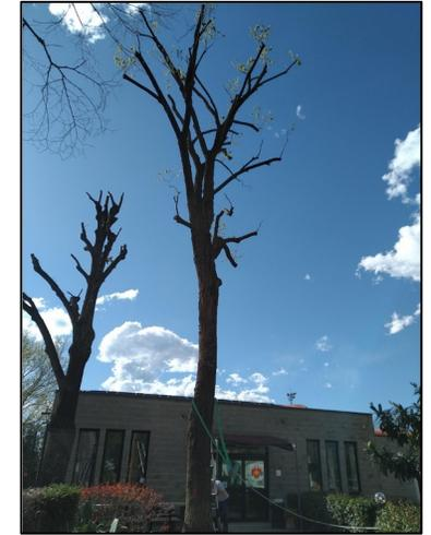
Prova di microtrazione, con cui viene esercitato un carico controllato all'albero, mediante funi e cavo in acciaio, che provoca minimi movimenti della zolla ipogea, registrati da uno o più sensori elettronici applicati al colletto.
