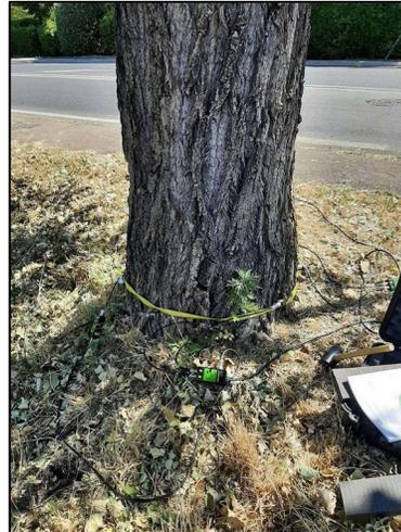
Applicazione di più sensori piezometrici disposti in numero pari (8-10-12) nella sezione da esaminare, successivamente percossi.
